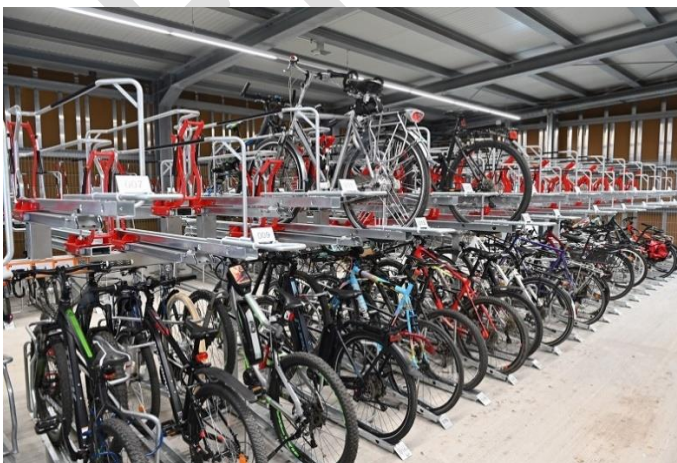
Abb. 9: Doppelstockparker in einer Fahrradstation am Bahnhof Trier
