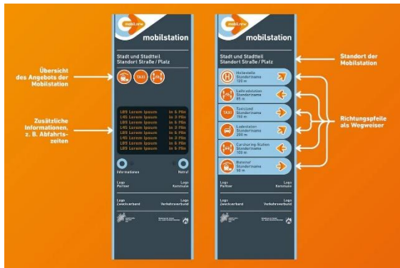
Abb. 2: Aufbau einer Informationsstele
